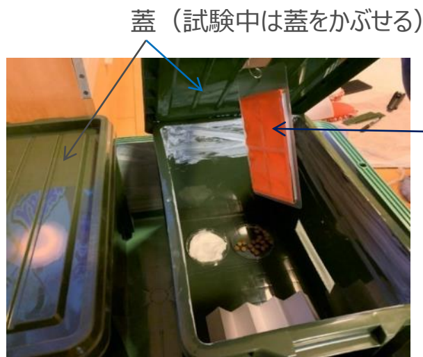
写真 4. レイシス設置の様子 (蓋裏に吊り下げ)
